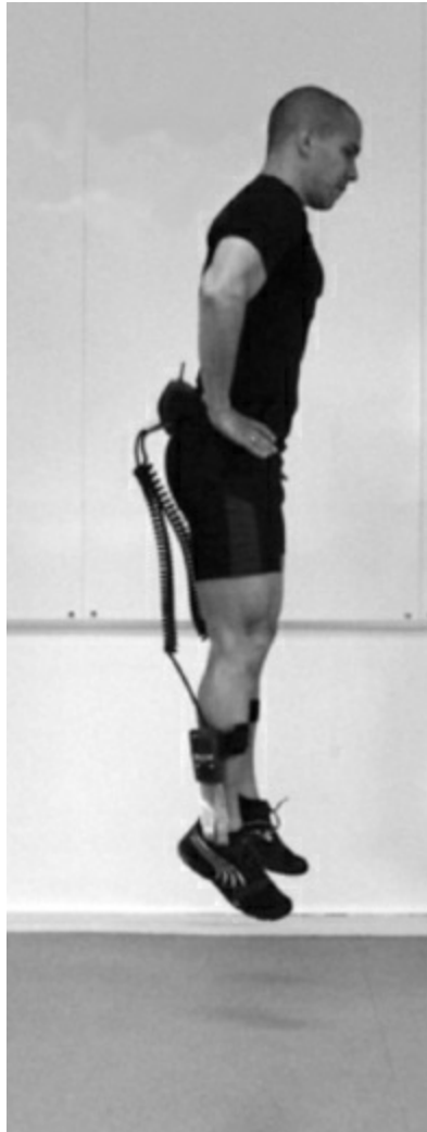
Figura 20. Realización de un salto con plantillas de presión.
