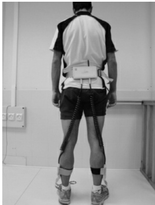
Figura 6. Deportista preparado para la exploración de la marcha y carrera con sistema Biofoot/IBV® de plantillas instrumentadas.
