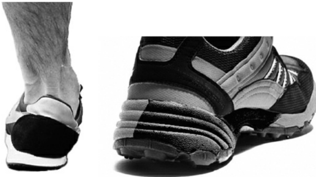
Figura 7. A la izquierda observamos el apoyo de un pronador en carrera. El retropié está valguzado, la parte medial de la suela está muy comprimida y la zapatilla deformada. A la derecha se ve una zapatilla con un sistema antipronación: la suela de densidad dual. La parte medial (oscura) de la entresuela tiene una densidad mayor y es más resistente a la compresión. Obsérvense también los refuerzos en la zona que acoge al talón para que éste quede bien fijado.
