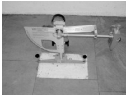
Figura 7. Péndulo TRRL para la medición de la fricción longitudinal del pavimento.
