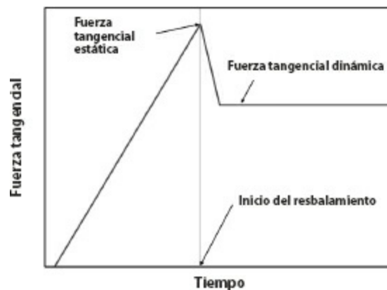
Figura 3. Representación de una curva típica para la determinación de los coeficientes de fricción estático y dinámico. Para el ensayo se aplica una fuerza normal (vertical) constante, a la vez que la superficie o el zapato se deslizan a velocidad constante. Hasta el instante de iniciarse el resbalamiento, la fuerza tangencial va aumentando progresivamente y a partir de ahí cae y pasa a ser más o menos constante durante el resbalamiento. El coeficiente de rozamiento o fricción es el cociente entre la fuerza tangencial y la fuerza normal. Para el coeficiente de rozamiento estático se toma la fuerza tangencial máxima alcanzada. Para el coeficiente de rozamiento dinámico se toma la fuerza tangencial dinámica (durante el resbalamiento).
