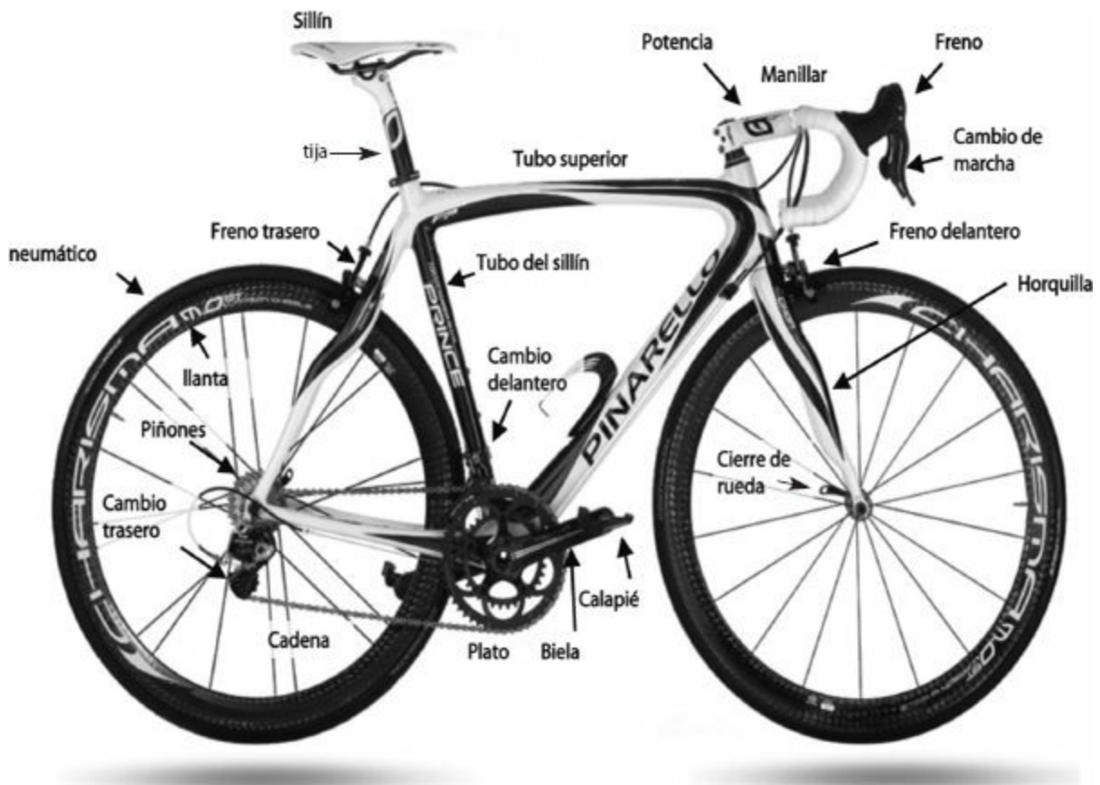
Figura 3. Componentes principales de la bicicleta. (Modificado de Mellion, 1991.)
