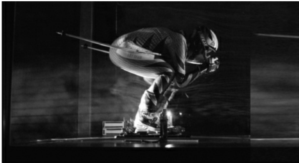
Figura 7. Carolina Ruiz, primera esquiadora finalista de la Copa del Mundo de Velocidad. Visualización de flujo y medidas de fuerzas aerodinámicas en el túnel de viento de la universidad de Granada (UGR).
