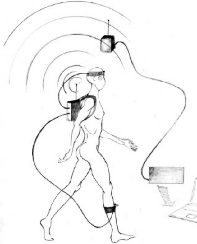
Figura12. Esquema de funcionamiento de un equipo de acelerometría inalámbrica con dos acelerómetros (tibia y cabeza).
