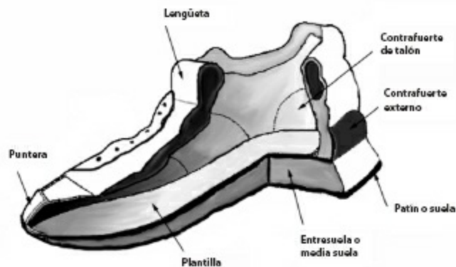
Figura 1. Partes de una zapatilla deportiva básica.
